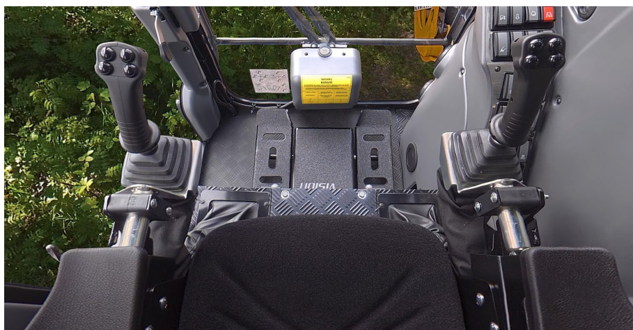
Obrázek 1. Kabina KESLA Vision & KESLA proPILOT 2+2 Hydraulický Ovládací Systém
