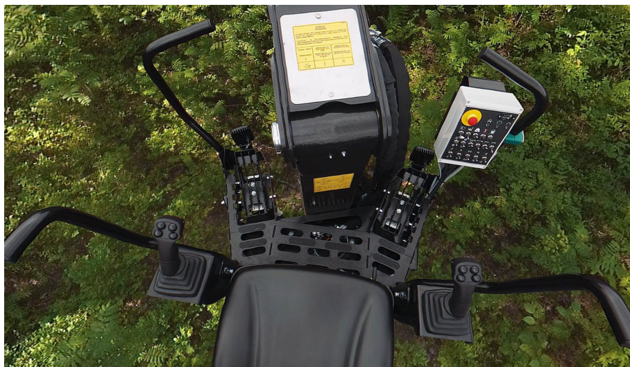
Obrázek 2. KESLA se sedačkou a ovládáním KESLA proPILOT hydraulicky ovládané joysticky
