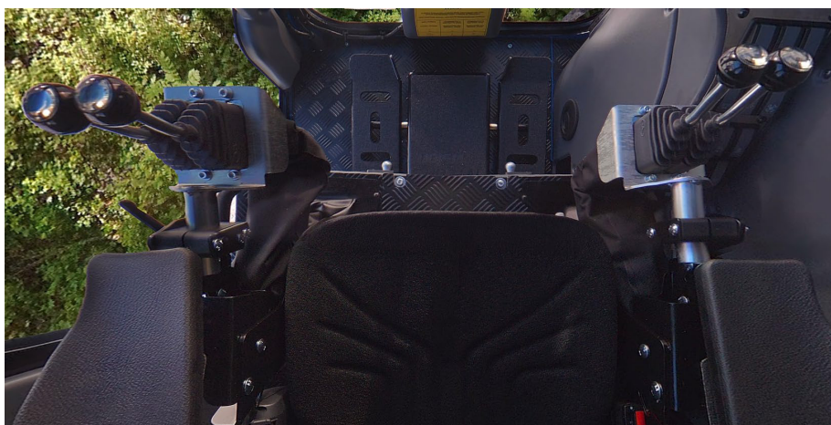
Obrázek 2. Kabina KESLA Vision & KESLA proPILOT 4+2 Hydraulický Ovládací Systém
