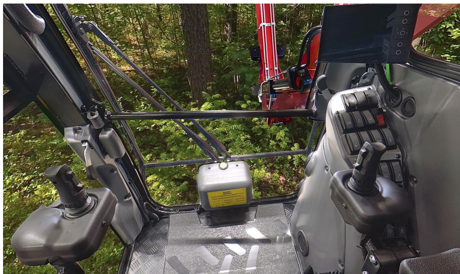
Obrázek 3. Kabina KESLA Vision s elektricky ovládanými mini joysticky KESLA proC i 2.0
